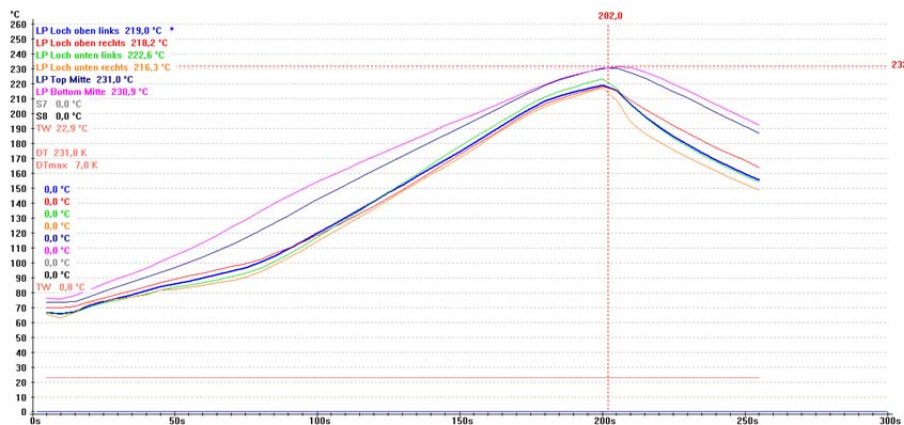
Abb. 24: Lötprofil Rework, Zieltemperatur 230°C
