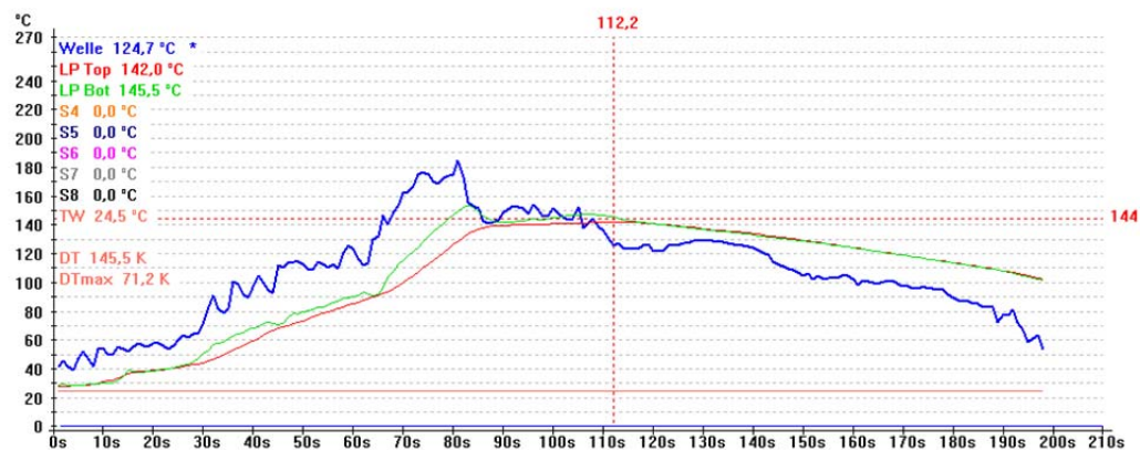
Abb. 15: Lötprofil Wellenlötten: „Welle aus“ Max. Temperatur: LP Bot 153°C, LP Top 142°C
