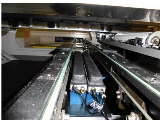
Abbildung 10: Vakuum Nest - Unterstützung
