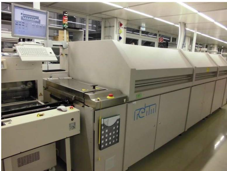
Abbildung 20: Reflowofen der Firma Rehm
