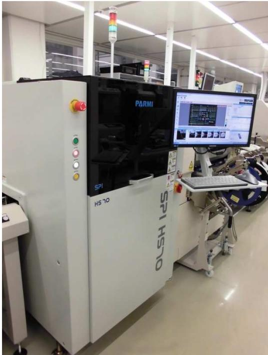
Abbildung 12: 3D-Inspektionsgerät HS70
