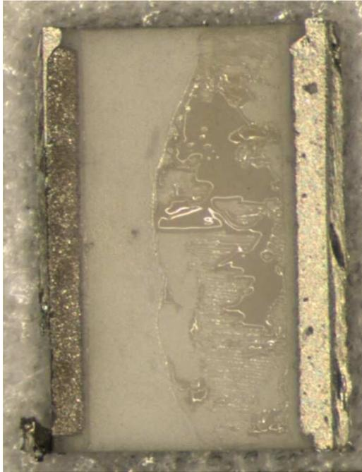
Abbildung 102: Bruch in der Metallisierung und im Lot
