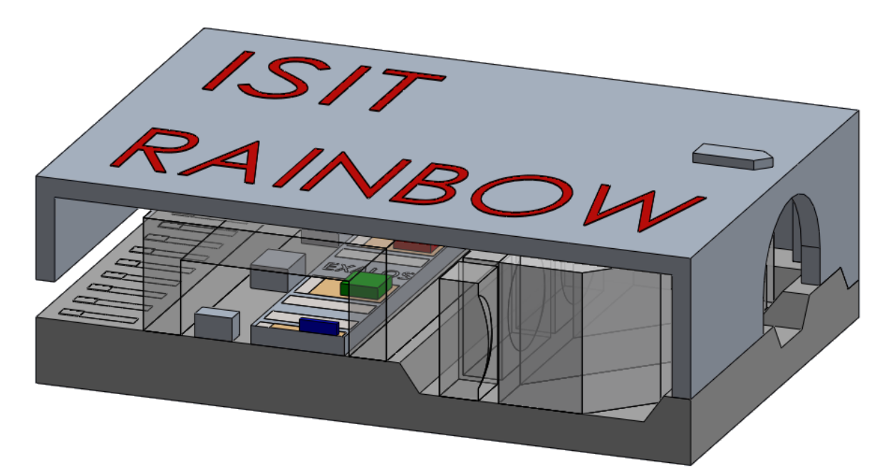
Abb. 7: Konstruktion eines miniaturisierten Lasermoduls mit freier Strahlführung und Power-Monitoring. Die Glaskappe mit sehr dünnem Austrittsfenster erlaubt eine laterale Strahlauskopplung. Die Größe beträgt 6.8mm x 7mm x 2.9mm (IP US 10,283,930 B2).
